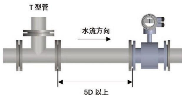
图 5 流量计前端有 T 型管的直管段
