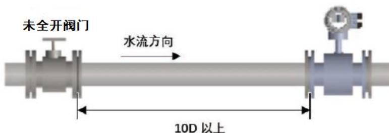
图 7 流量计前端有未全开阀门的直管段
