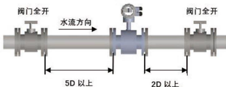
图 4 有前后阀门的直管段
