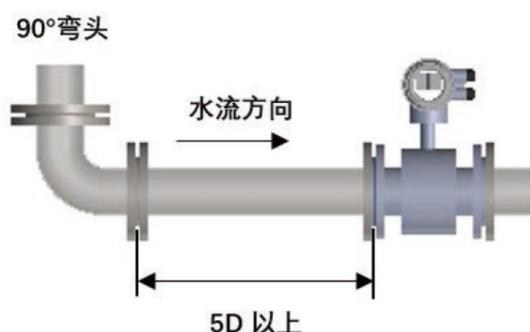
图 6 流量计前端有 90° 弯管的直管段
