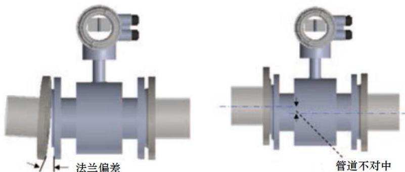
图 3 流量计配管
