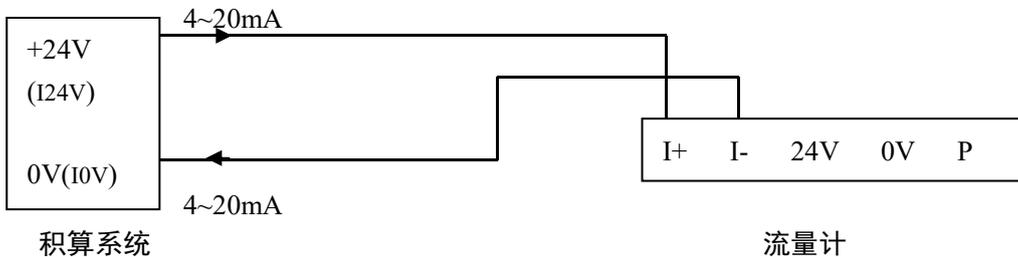
注：① 有电池供电的型号和无电池供电的型号接线端子对应关系：
