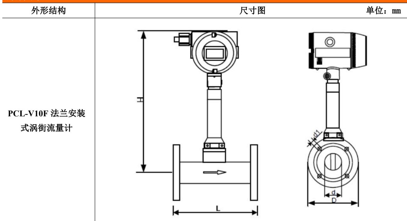
上图中，L 代表流量计测量管长度；D 代表流量计法兰直径；H 代表表头顶端与管道接口中心间的长度。法兰安装式涡街流量计外形尺寸表，如下表 1。
